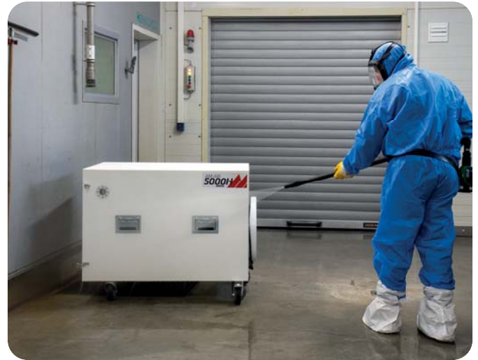
Dekontaminierung im betriebseigenen Schwarzbereich nach TRGS 519-8.2 (8)
